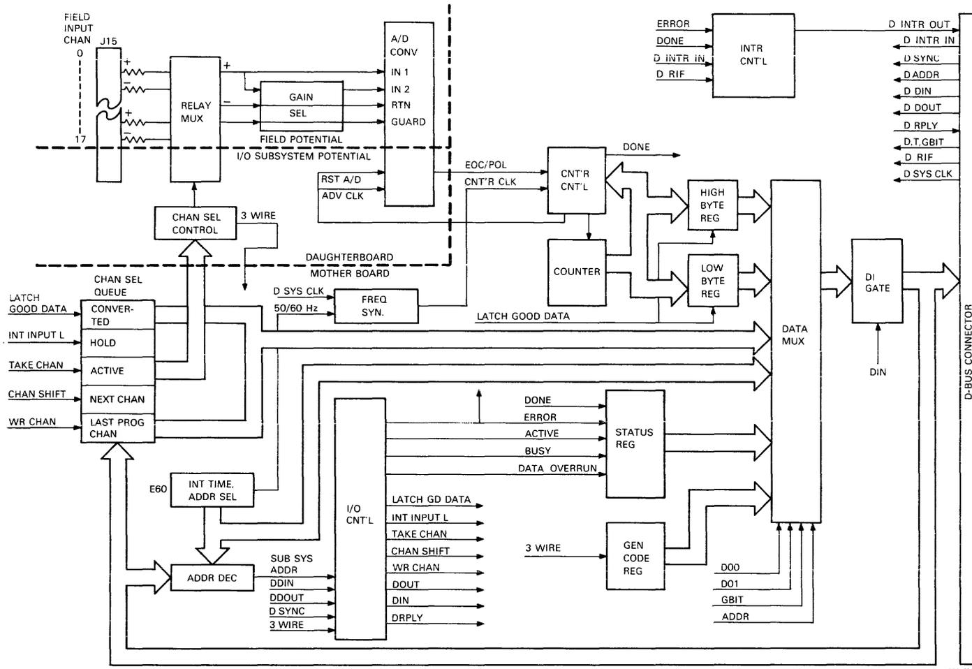
Figure 6-21-1 A020 Block Diagram
