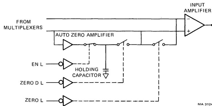
Figure 6-20-4 Auto-Zero Circuit
