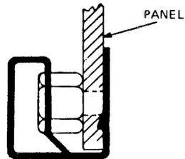
NOT-RECOMMENDED ASSEMBLY USING U NUT RETAINER 90-07786-01
