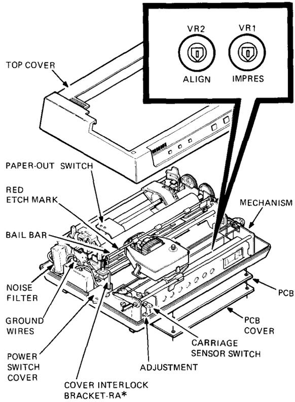
\* SWITCH SHOWN IS USED ON RA MODEL PRINTER
