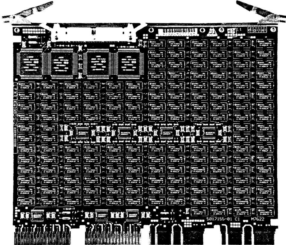
Figure 1-5 MS650 Memory Module (16 MB)
