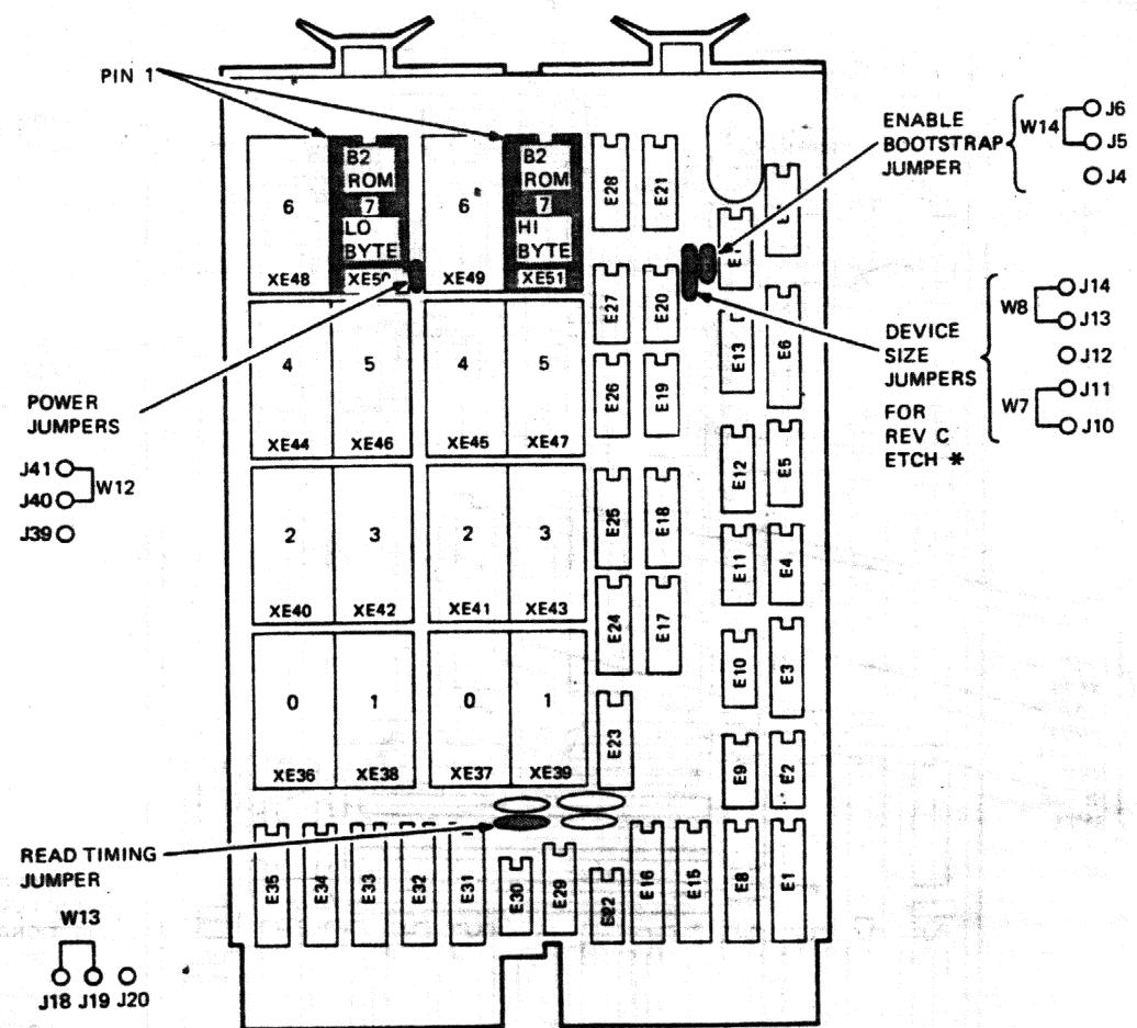
\* FOR REV D ETCH CONNECT W7 FROM J11 TO J12. THE ETCH REVISION IS FOUND ON THE LEFT SIDE OF THE BOARD COMPONENT SIDE UP, HANDLES FACING AWAY.
