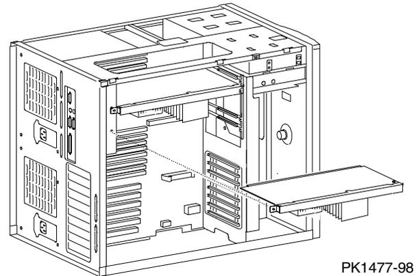
**Figure 5 CPU Installation in DS20E Systems**
