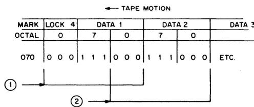
Figure 3-8 Mark-Track Decoding (MK DATA 070)
