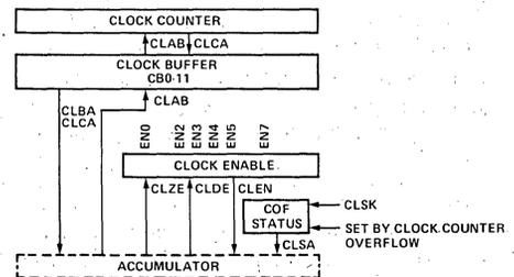
**FIGURE 5 RTC REGISTERS**
