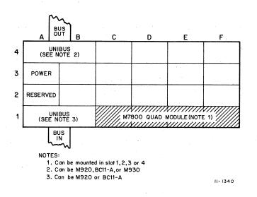
Figure 3-1 DL11 (M7800 module) Mounted in DD11-A
